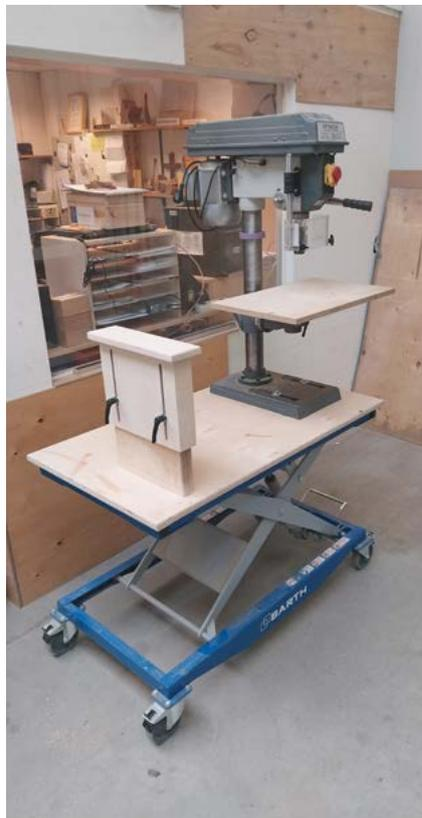
Die Bohrmaschine wurde höhenverstellbar installiert, sodass auch ein kleinerer Beschäftigter gut daran arbeiten kann.
